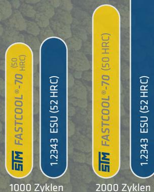
Niedrigere Werte für den Abrieb bedeuten höhere Verschleißbeständigkeit unter den getesteten Bedingungen.
